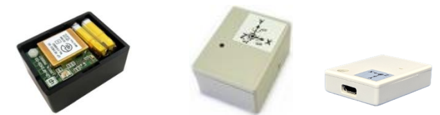
小型9軸ワイヤレスモーションセンサ
