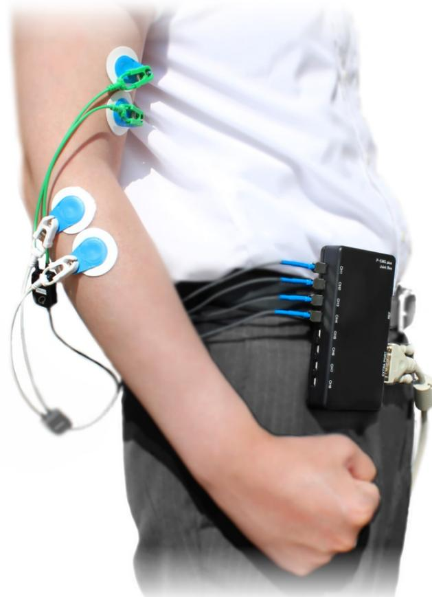
JointBox はセンサと本体の間に接続する中継ボックスです。
