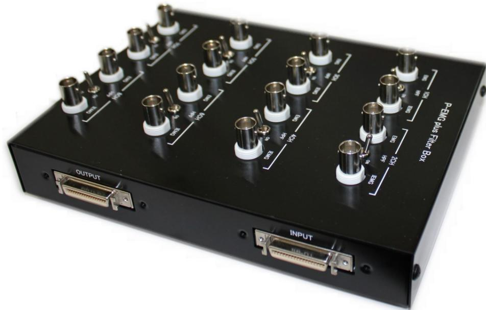
FilterBox は本体の出力に接続する BNC コネクタ変換ボックスです。内部にアナログのハイパスフィルタと IEMG 生成回路が内蔵されており、各チャンネル毎の EMG と IEMG 信号が BNC コネクタにて出力可能です。本製品を既存の研究システムへ接続する場合等に大変便利です。
