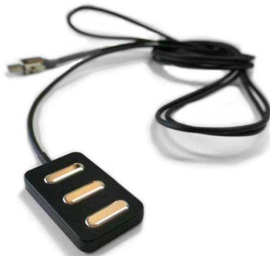
Branched electrode は、通常の差動増幅回路とは違う特殊な入力構造を用いることで、クロストーク(周辺筋電の混入)を低減させ、計測対象の筋からの筋電のみを計測可能とした乾式タイプの表面筋電位センサです。
